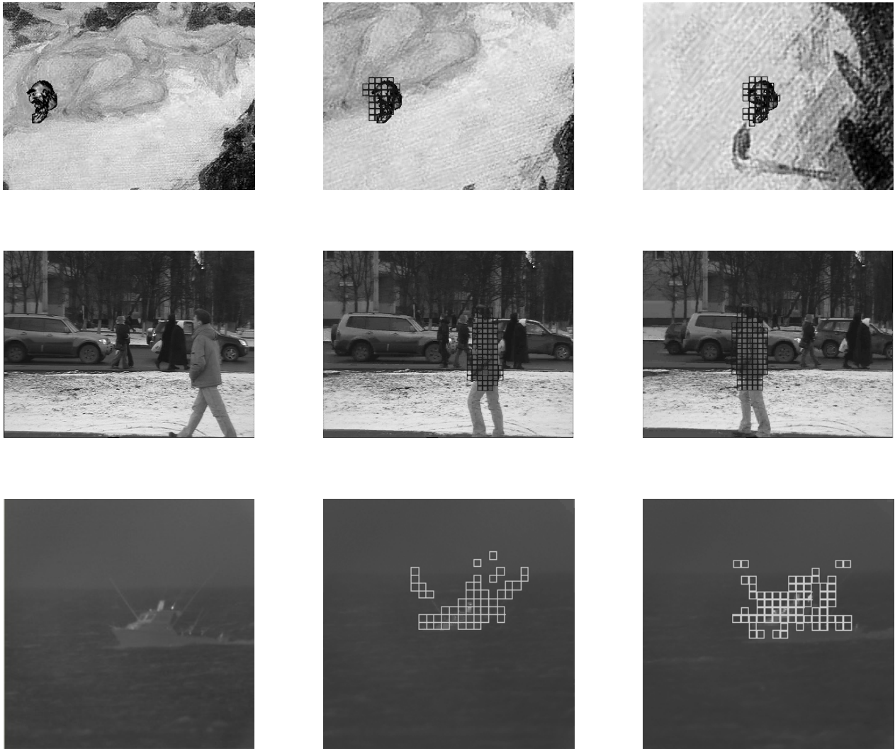
Рис. 4. Результаты работы алгоритма. Квадратами обозначены части, определенные как принадлежащие объекту. В верхнем ряду представлены результаты работы алгоритма на синтетических кадрах. В среднем – сопровождение человека на нестационарном фоне. В нижнем – сопровождение лодки на водной поверхности с яркими информативными бликами при перемещающейся камере. На изображениях нижнего ряда видно, что определились как части объекта даже удочки и антенны.
