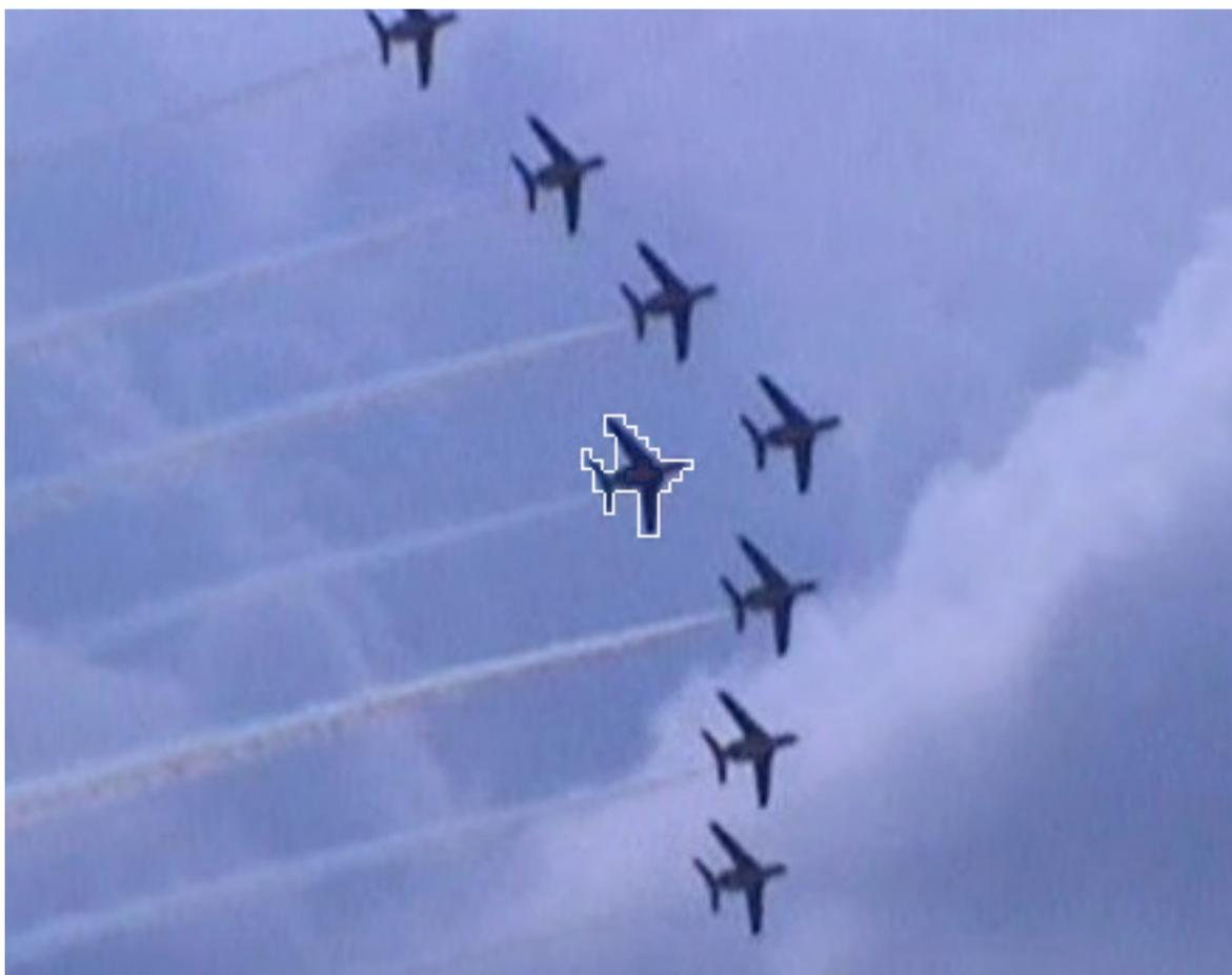
**Рис. 3.2. Определение контура объекта по контрастности.**
