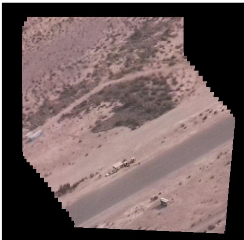
**Рис. 2.15. Пример построения мозаики с использованием проективных преобразований.**
